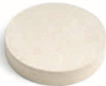
Disco de fieltro natural con sistema de anclaje tipo velour que junto con la pasta de pulir verde o rosa obtiene el más exigente acabado espejo sobre superficies de acero inoxidable. Utilizar con el plato M14. Soporte Hookit diámetro 115.
