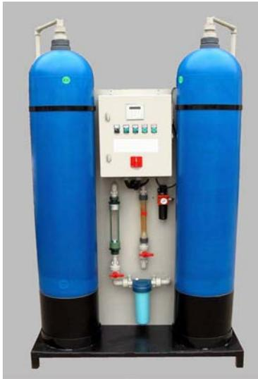
Las unidades de purificación PERMAPASS 3095 están diseñadas para extraer selectivamente las contaminaciones de hierro y zinc en soluciones de pasivado PERMAPASS 3095 basadas en cromo III, gracias a la acción de una resina de intercambio iónico de tipo quelante, denominada PERMAPASS 3095 IER.
