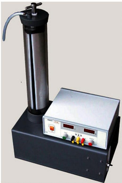
Equipo para la recuperación de plata mediante la deposición electrolítica del metal sobre cátodos de acero inoxidable que reduce el contenido de plata en la solución de vertido.
