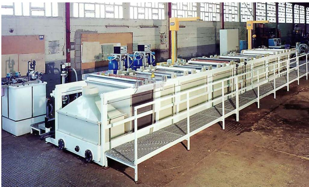
Los carros transportadores tipo "G" de accionamiento automático, pueden emplearse para actuar simultáneamente en dos líneas paralelas, si por motivos de espacio fuera preciso el fraccionamiento de la línea.
