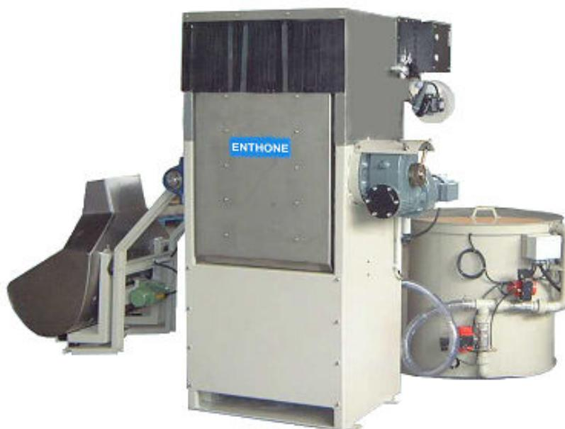
Las **CENTRÍFUGAS "T" AUTOMÁTICAS para Secado y Lacado** están especialmente diseñadas para el secado con aire caliente de piezas, sin manchas ni rozaduras permitiendo, además, líneas de procesos personalizadas para tratamiento de piezas.
