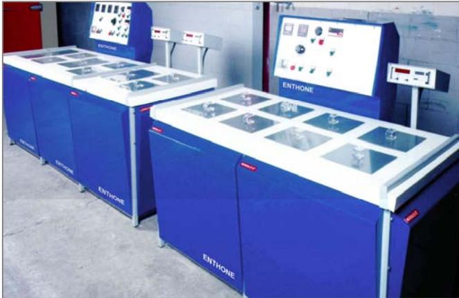
Los equipos **MINI MODULE-X** están especialmente estudiados para pequeñas producciones de piezas, básicamente adaptados para laboratorios de joyería, electrónica y ensayo de procesos.
