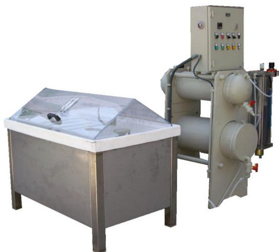
Los equipos **NIEBLA SALINA E-84** están especialmente diseñados para ensayos de corrosión acelerada.
